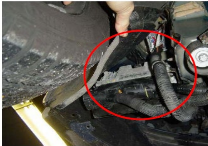
Abbildung 7: kritischer Einbauort bezüglich Korrosion und Wasserlast
